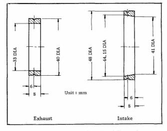
Fig. EM-60 Valve Seat Insert
