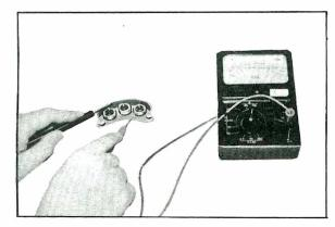
Fig. EE-34 Positive Diode
